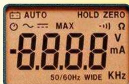
Ecran LCD à afficheur 10 000 points, muni d'un rétro-éclairage.
